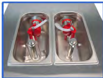
Depósito con agitador y bomba de aire
