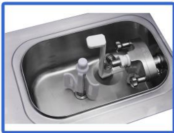
2 depósitos con agitador, bomba de aire y sonda de nivel
